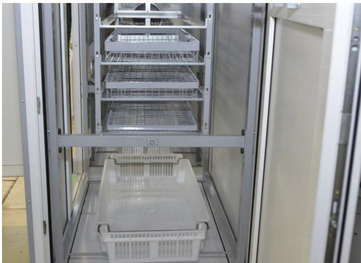
Большое внимание компания-производитель уделяет технологиям энергосбережения. Непосредственно нагрев длится не более 30 % времени от всего процесса инкубации. Поддержание температуры внутри камеры обеспечивается теплоизоляционным материалом — пенополиуретаном. Если датчик контроля температуры покажет снижение её на 1 градус, то включится обогрев и за несколько минут поднимет значение до заданного.
